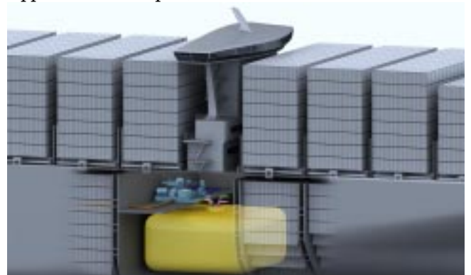
LNG fuel tank
